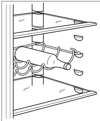
2. Acest raft poate fi înclinat pentru a depozita sticle care nu sunt închise hermetic. Pentru a realiza acest lucru, puneți cărligile din partea frontală a raftului pe un nivel mai ridicat decât cel pentru cărligile din spate.
